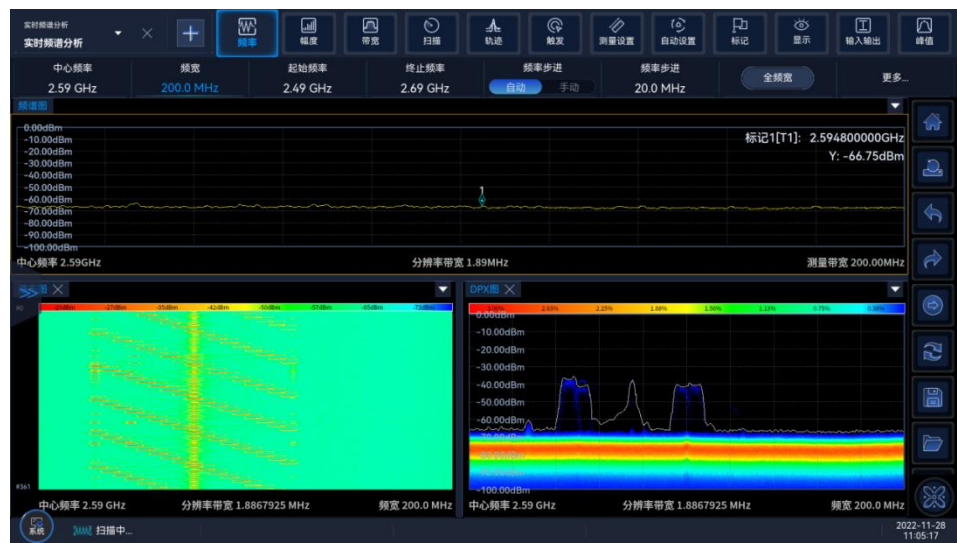
图 4.34 数字荧光图谱测得的手机通信信号
