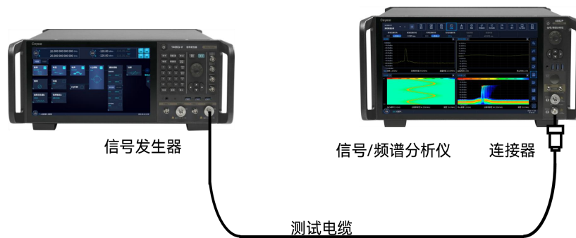
图 4.29 杂散发射测量连接设置
