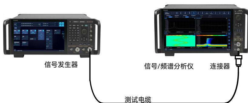
图 4.15 功率统计测量连接设置
