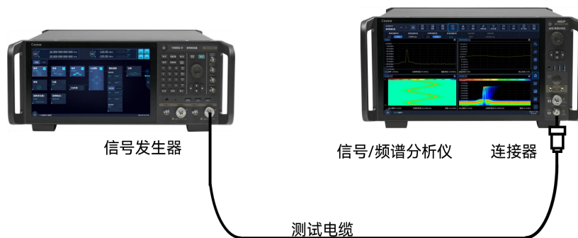
图 4.19 邻道功率测量连接设置
