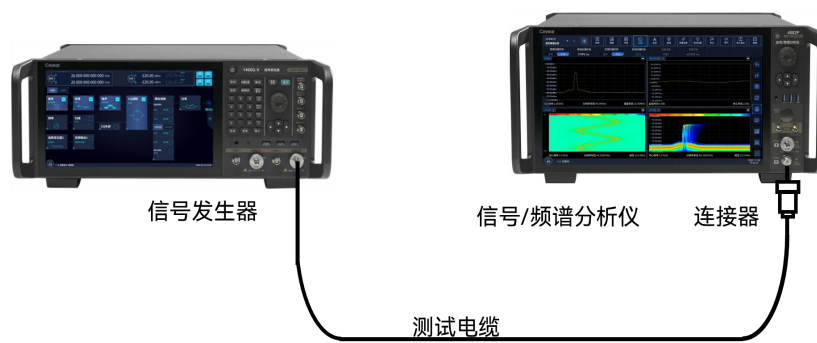
图 4.23 突发功率测量连接设置
