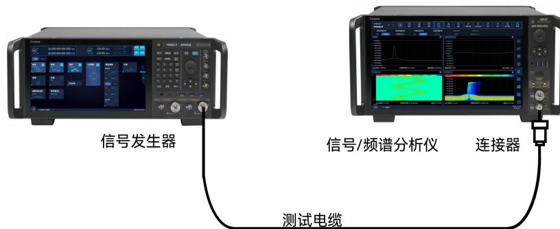
图 4.13 占用带宽测量连接设置
