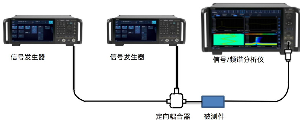
图 4.27 三阶交调测量连接设置
