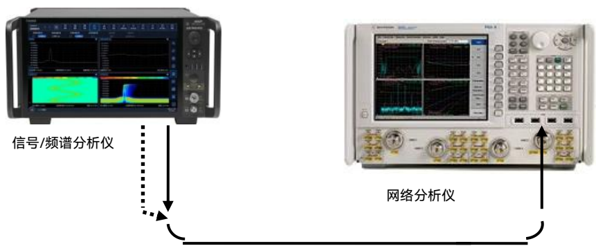
图 7.21 输入端口电压驻波比测试示意图
