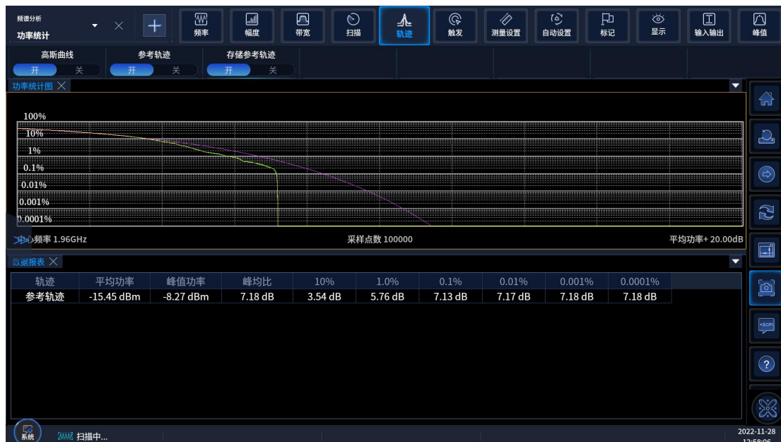
图 4.17 存储和显示 CCDF 测量
