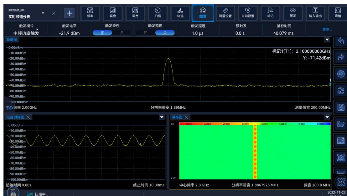
图 4.44 中频功率触发设置示意图
