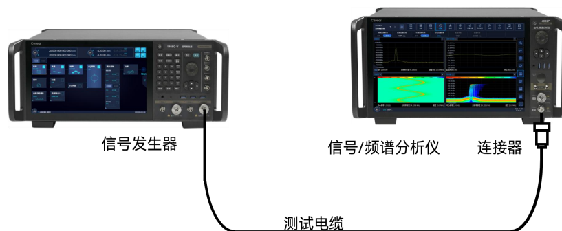
图 4.37 实时频谱分析模式连接设置
