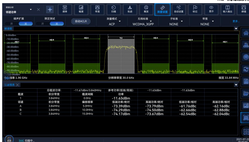
图 4.21 测量第三邻道
