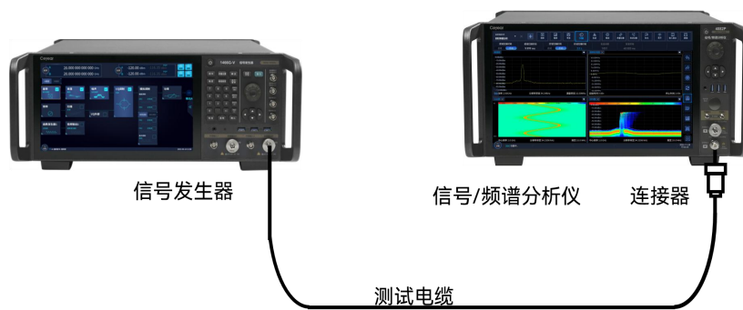
图 4.10 相位噪声测量连接设置
